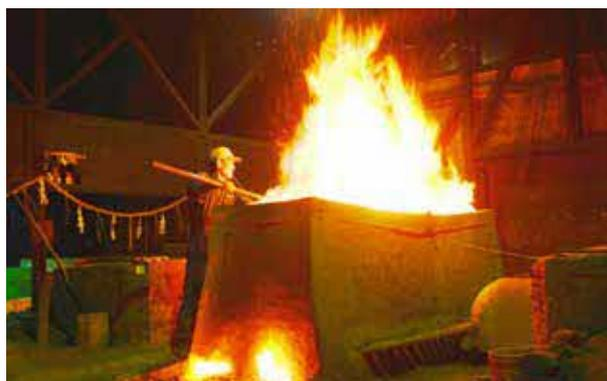
図 3-33 玉鋼製造（たたら吹き）
